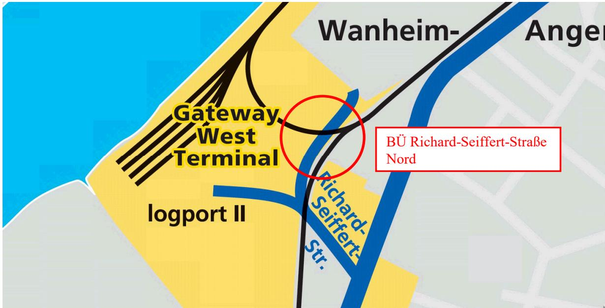
Der mit Lichtzeichen und Halbschranken (LzH / F) technisch gesicherte BÜ Richard-Seiffert-Straße Nord befindet sich auf dem Gelände des Logport II ca. 100m südwestlich der Anschlußweiche 08W22.
